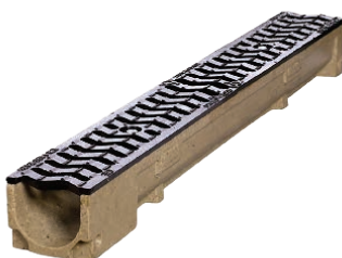
Odwodnienie H = 10 cm z kratą żeliwną B125 wytrzymałość 12,5 tony
